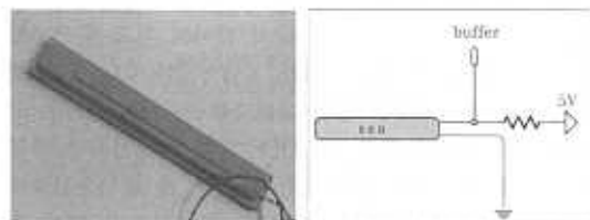
그림 2 ON/OFF 스위치 센서의 외형과 회로도
